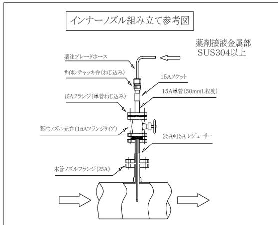
コントライムM-900は酸性液体品ですので配管注入の際は左記のインナーノズル(例)をご使用ください。
